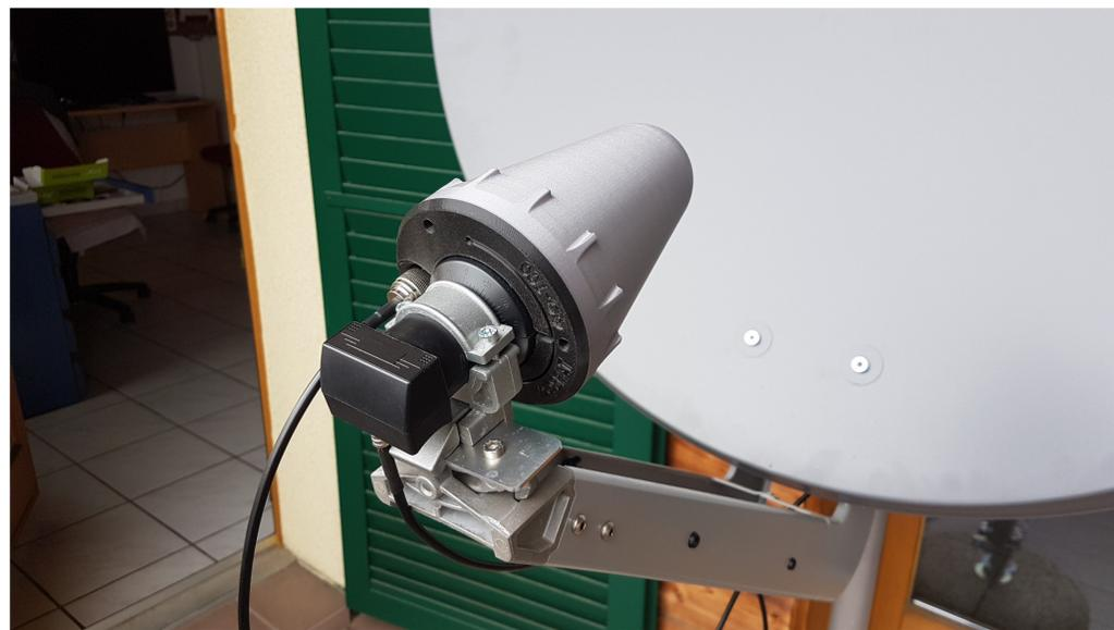
Die Druckdaten enthalten alles was es zum Bau der Antenne benötigt inkl. Werkzeuge, wie einen Wickelkörper für die Helix und eine Drehaufnahme um das Reflektorblech auf einem Drehbank zu bearbeiten.
